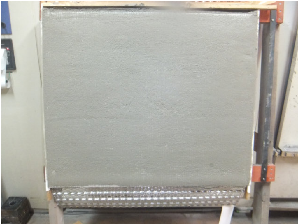
写真8 35mm施工完了後
